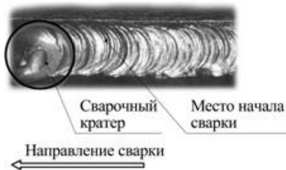
Рис. 7.3. Начало сварки при смене электрода.
