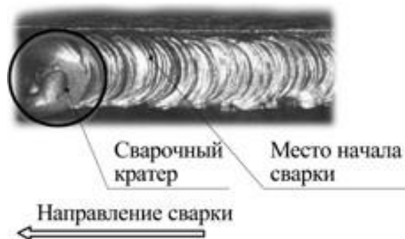
Рис. 7.3. Начало сварки при смене электрода.
