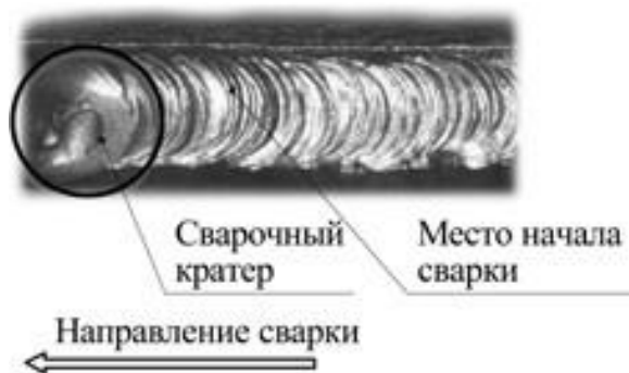
Рис. 8.3. Начало сварки при смене электрода.
