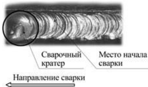
Рис. 7.3. Начало сварки при смене электрода.
